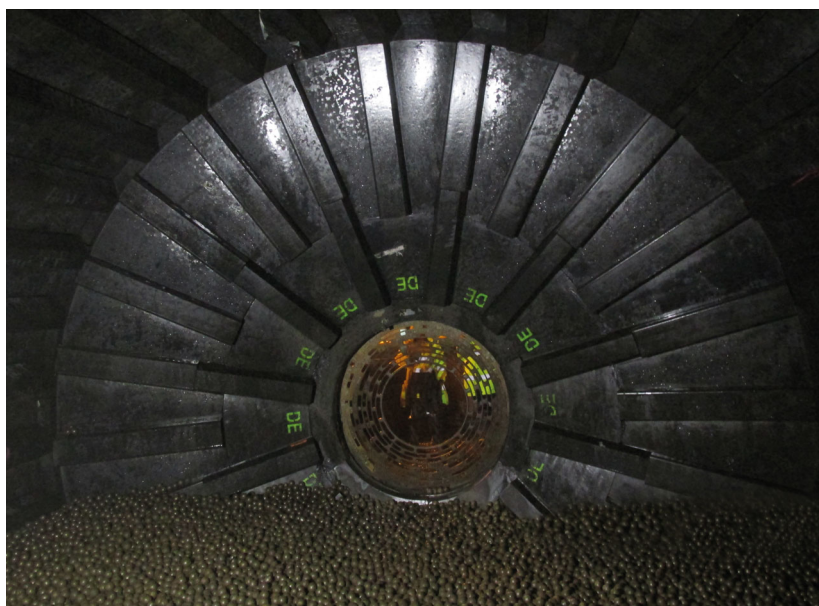
Рис. 3. Резиновая футеровка мельницы производства «PT Growth Asia»
