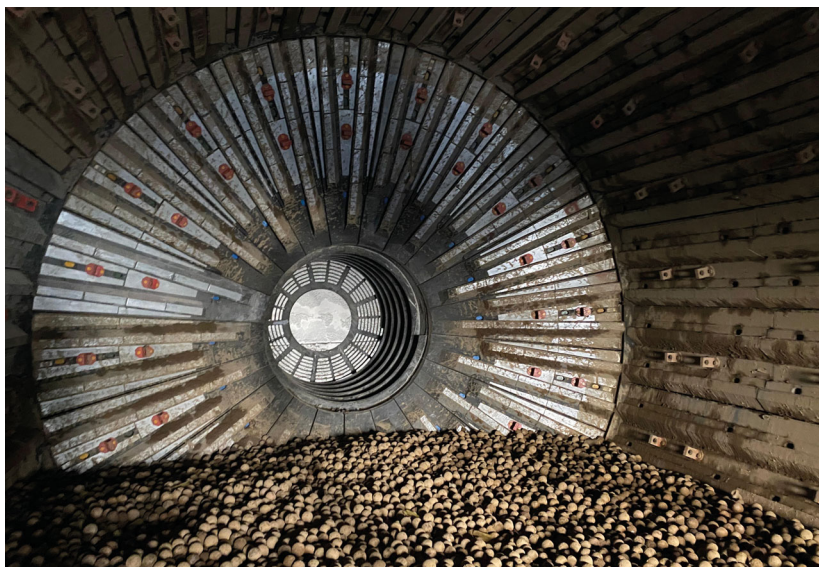
Рис. 2. Резино-металлическая футеровка мельницы производства «PT Growth Asia»
