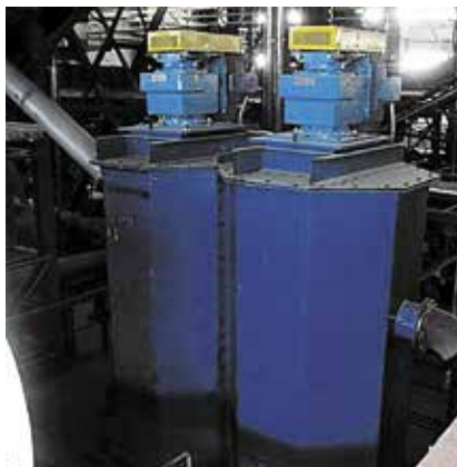
РИС. 5. Оттирочные машины в лабораторном и промышленном исполнении.
