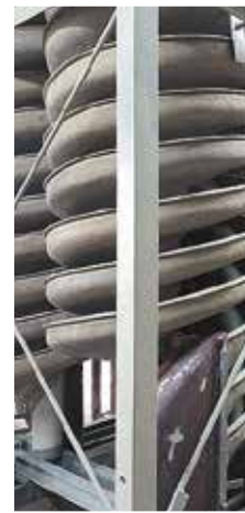
РИС. 6. Винтовые сепараторы в лабораторном и промышленном исполнении
