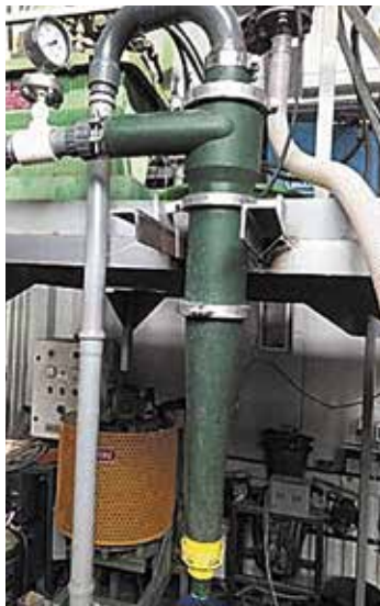
РИС. 4. Гидроциклоны в ЦИМС и на промплощадке ГОК
