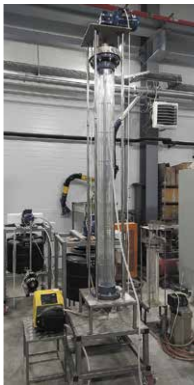
РИС. 8. Пастовые сгустители в лабораторном исполнении
