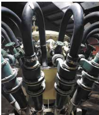
РИС. 4. Гидроциклоны в ЦИМС и на промплощадке ГОК
