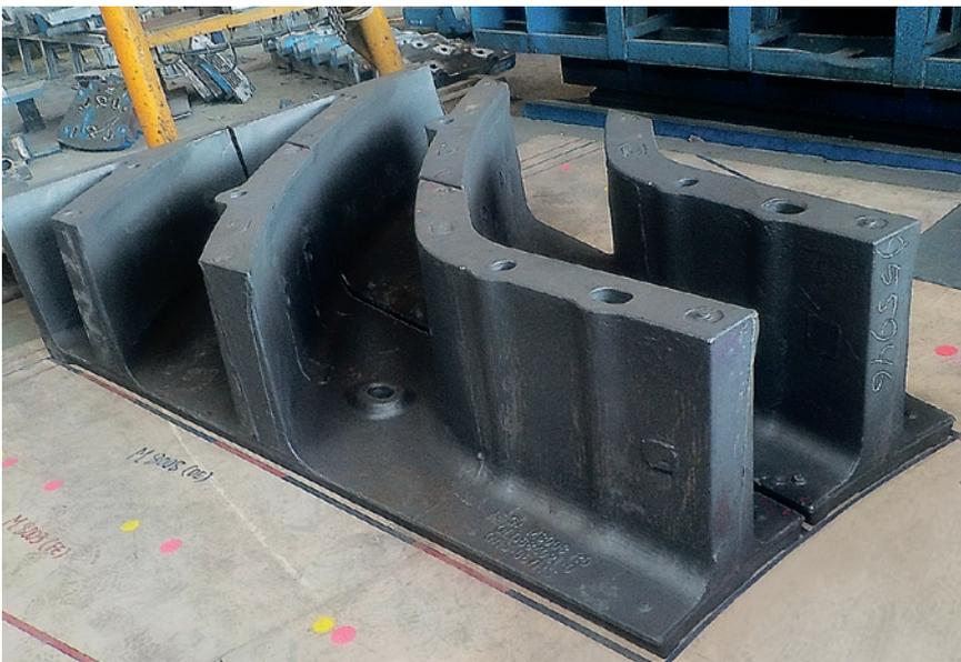
РИС. 4. Стальные криволинейные элеваторы торца разгрузки мельницы МПСИ
