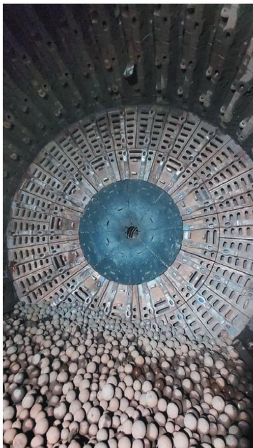
РИС. 1. Металлическая футеровка мельницы МПСИ и мелющие шары «PT Growth Asia»
