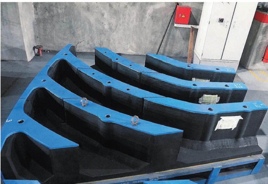
РИС. 5. Композитные криволинейные элеваторы торца разгрузки мельницы МПСИ
