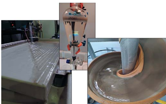
Рис. 3 Гравитационное обогащение в лабораторном и полупромышленном исполнении
