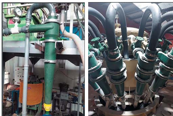
Рис. 4 Гидроциклоны в ЦИМС и на промплощадке ГОК
